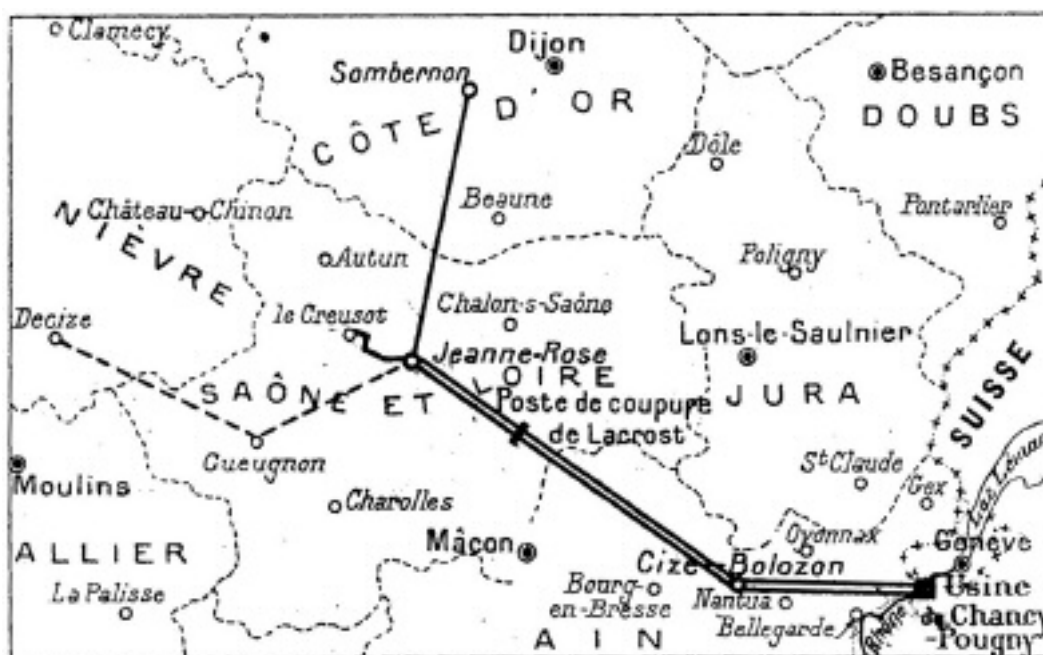
Carte montrant la ligne de transport d'énergie à 120 000 volts de Chancy-Pougny au Creusot (148 km) et à Somberron (206 km).
